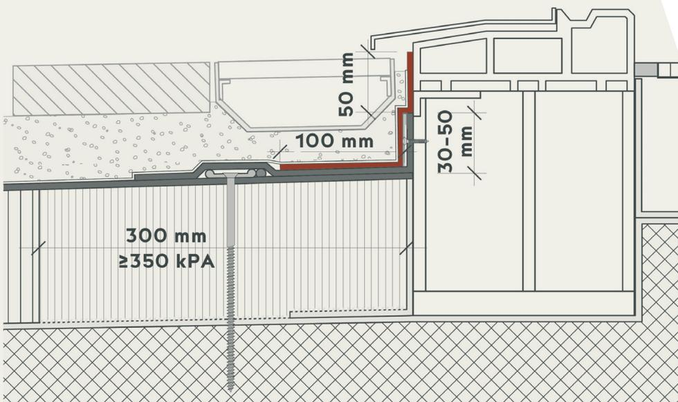
FLK-Anschluss auf Abdichtung aus Kunststoff-Dichtungsbahn bei Schwellenanschluss, Anschlusshöhe über Nuttschicht unter 60 mm. **Ausnahme-regelung** Norm SIA 271, Ziffer 5.2 beachten!
