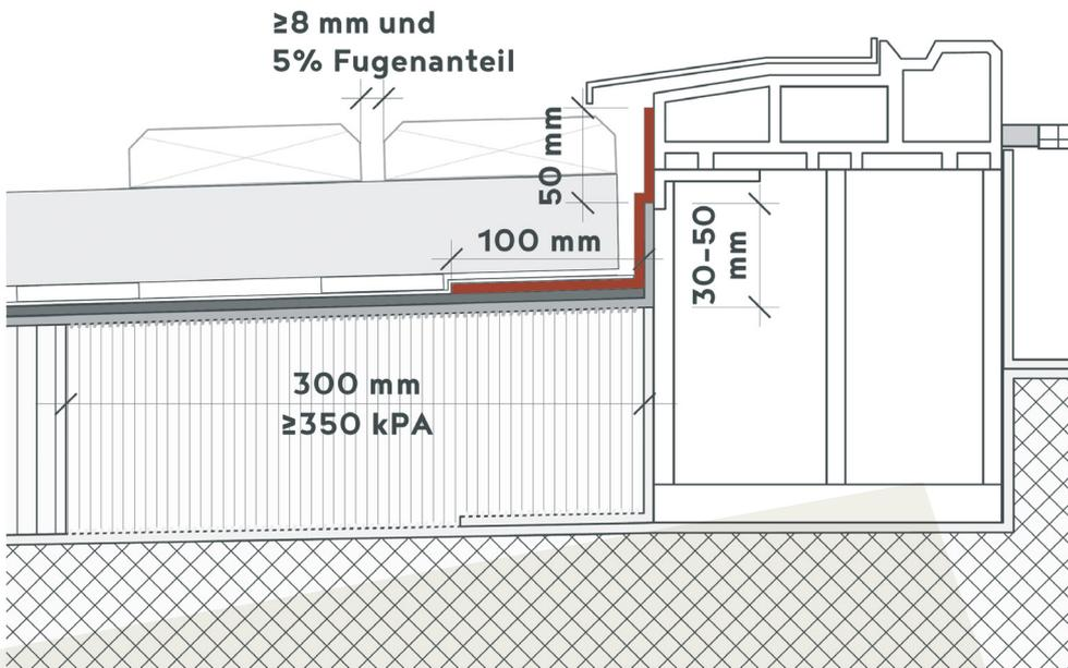
FLK-Anschluss auf zweilagiger bitumiger Abdichtung bei Schwellenanschluss, Anschlusshöhe über Nuttschicht unter 60 mm. **Ausnahme-regelung** Norm SIA 271, Ziffer 5.2 beachten!
