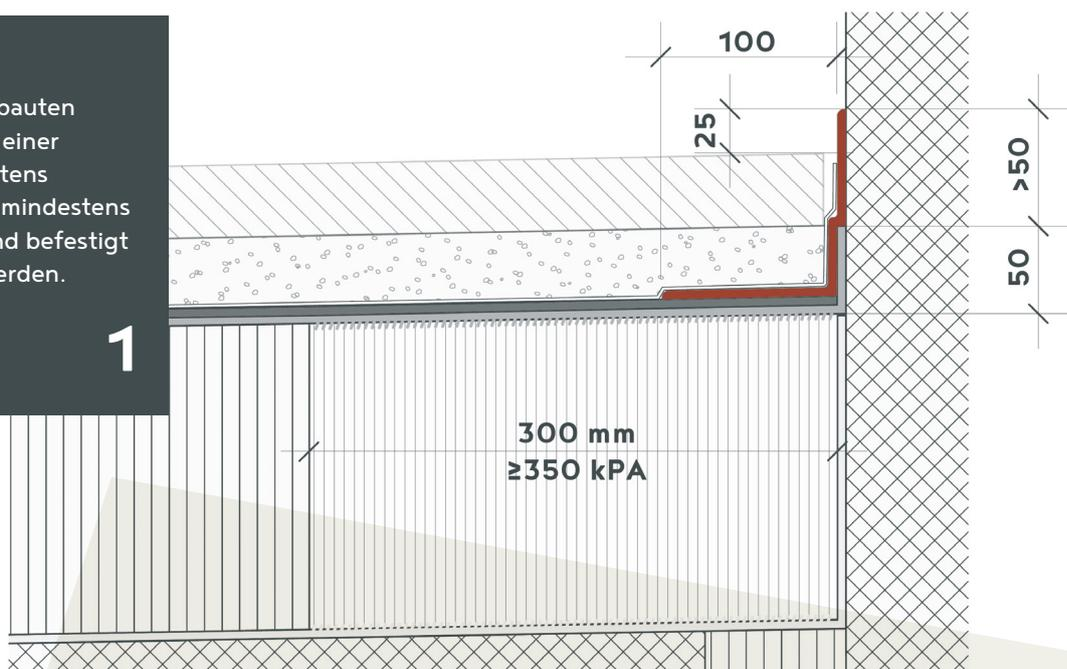
Oberer Abschluss mit FLK als Ersatz des Blechabschlusses. Die bitumige Aufbordung wird konventionell mit Keil und Eckverstärkung ausgeführt.
