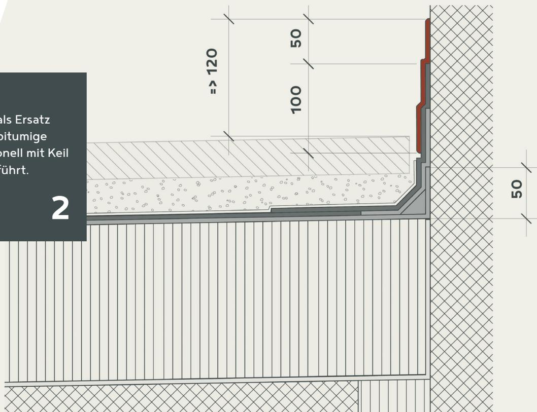
FLK-Abschluss bei einlagigen Abdichtungen auf starre Untergründe. Anschlussfläche 50 mm ab festem Untergrund.
